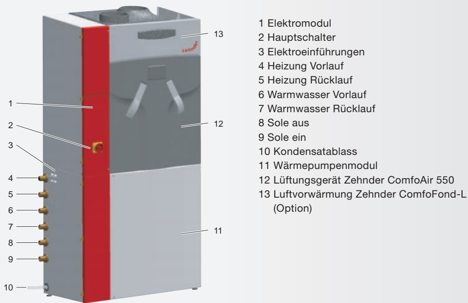
Fig. 3 Aufbau Zehnder ComfoBox
