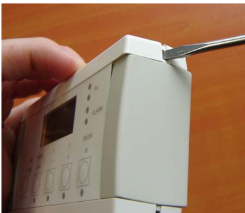
Benutzen Sie einen kleinen Schraubendreher zum Eindrücken der 4 Verriegelungen
